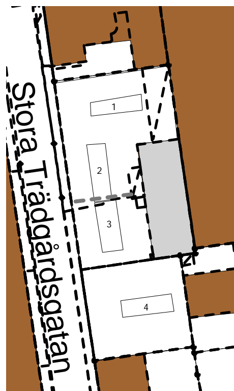
Figur 5. Schaktens placering vid undersökningen. Svart streckad linje markerar elkablar och grå streckad linje markerar avloppsledning. Skala 1:1 000. Kartunderlag © Malmö stadsbyggnadskontor.
